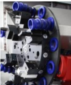
Estos modelos están equipados con la torreta Duplomatic con servo motor "FAST" y lógica bi-direccional. Esto, combinado con el sistema de fijación hidráulica sin mecanismo de levantamiento, reduce considerablemente el tiempo de posicionamiento de herramientas. La torreta con sistema de fijación VDI para 12 herramientas garantiza un rápido cambio de herramienta.
