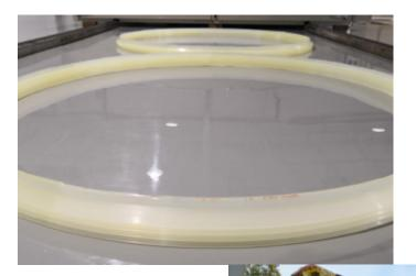
Adicionalmente a los sellos mecanizados, UTEC Sealing Solutions ha también mejorado el proceso de producción de sellos para tuneladoras (Tunnel Boring Machines – TBM). En nuestras instalaciones en Suzhou, podemos producir virtualmente cualquier dimensión de sello en poliuretano para TBM.
