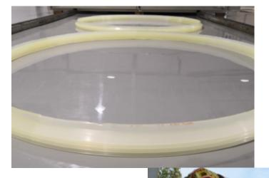
Além das vedações usinadas, a UTEC Sealing Solutions também melhorou o processo de produção de selos para tuneladoras (TBM). Em nossas instalações em Suzhou, podemos produzir praticamente qualquer tamanho de vedação para TBMs em poliuretano.
